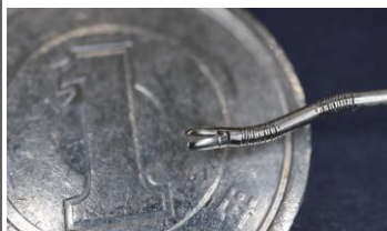
低侵襲微細手術用ロボット (直径0.9mm多自由度湾曲機構)
